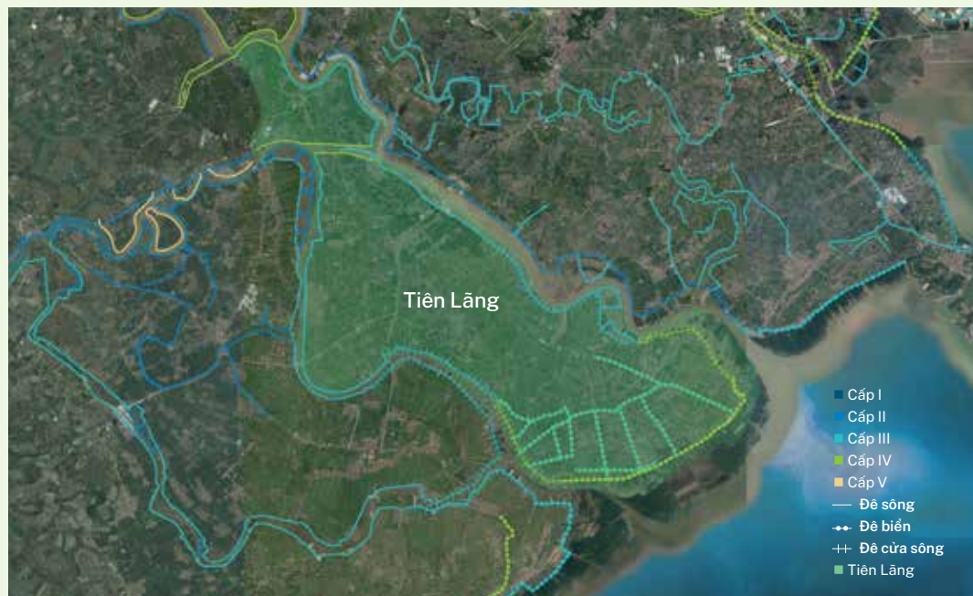
HÌNH B13.1 >> Huyện Tiên Lãng được 21 km đê biển và 57 km đê sông bảo vệ
