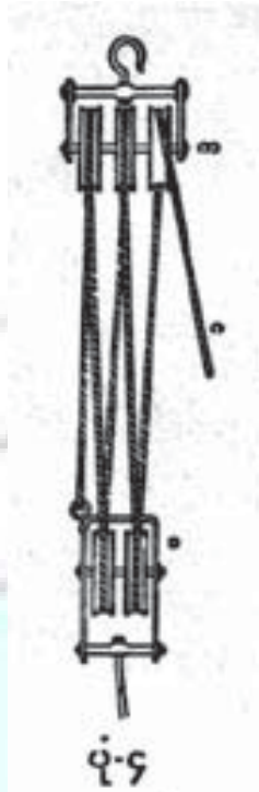
ဤစက်သီးတွဲမျိုးကိုသုံးလျှင် လူတစ်ယောက်သည် ၁ ၁/၂ တန်မျှ လေးသောဝန်ကိုပင် ပေါ့ပါးလွယ်ကူစွာ မယူနိုင်ပေသည်
