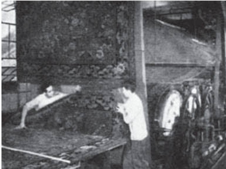
ကော်ဇောမျက်နှာပြင်ကို စက်ဖြင့်ဖြတ်ညှိပေးခြင်း
