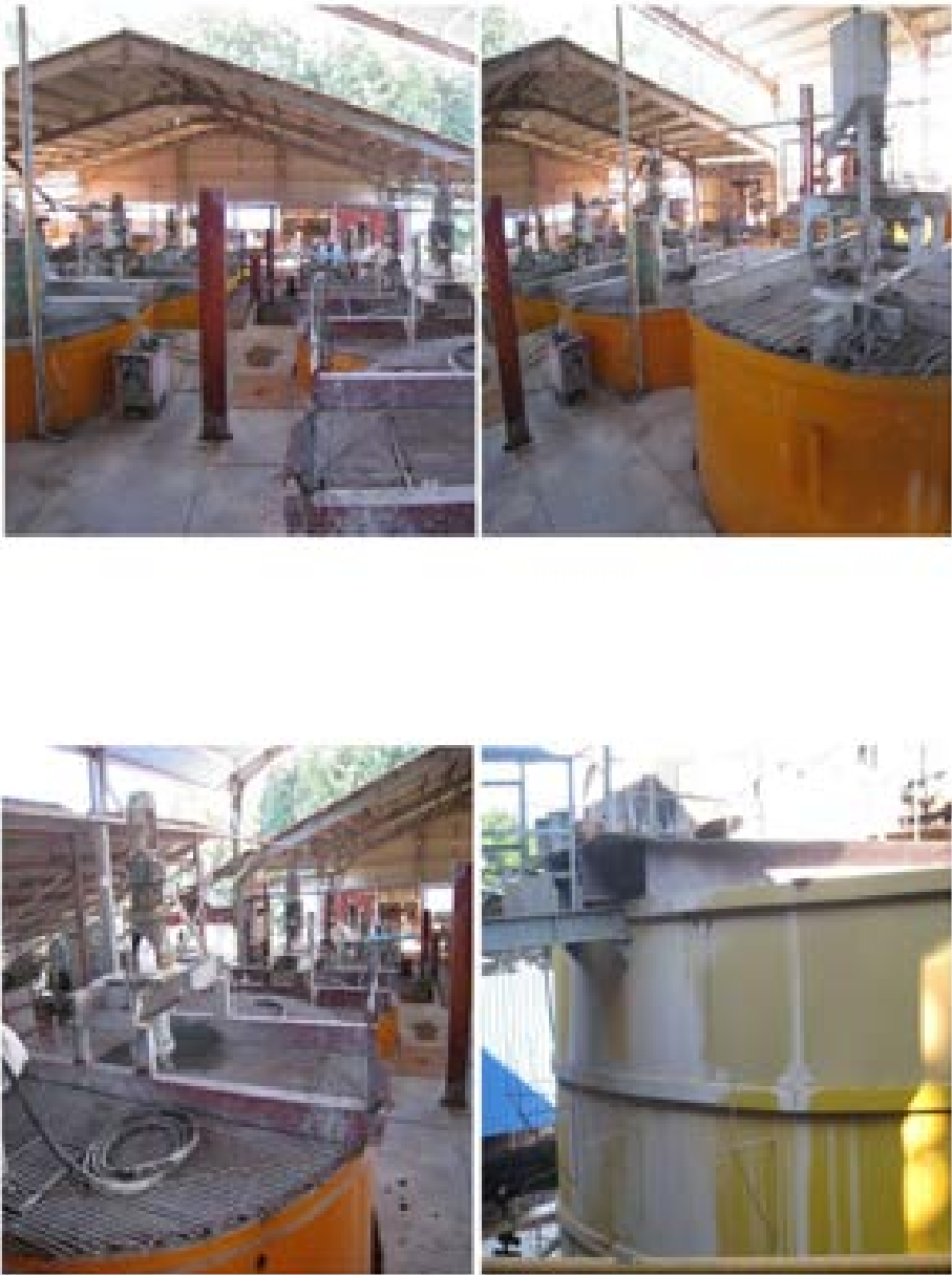
Leaching Tank & Absorption အသုံးပြုခြင်း
