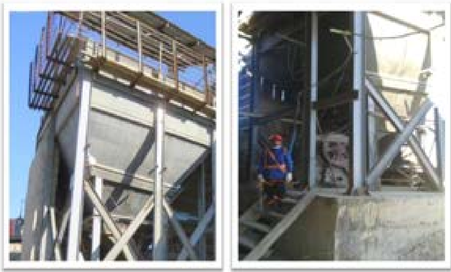
ရွှေသတ္တုပါပြွန်းကျောက်စာများ စတင်ကြိတ်ဖွဲခြင်းဆောင်ရွက်ပုံ(Hopper)
